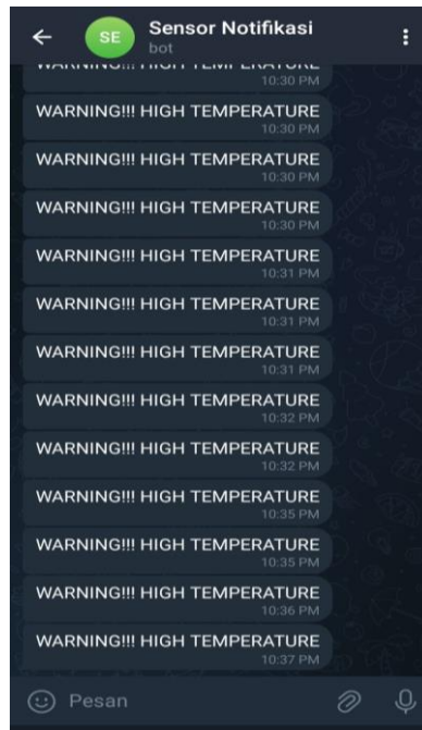
Gambar 5. Tampilan notifikasi DHT11 pada Telegram
